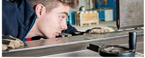
In der Werkstatt muss man exakt arbeiten – besonders beim Biegen oder Abkanten. Schließlich müssen die Bauteile auch zu 100 % ineinander passen!
